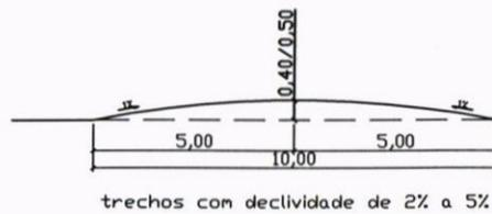
**Corte esquemático - Lombadas**
