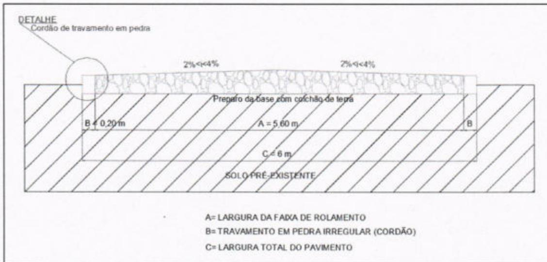
Figura 06: Detalhe em corte transversal do Pavimento
